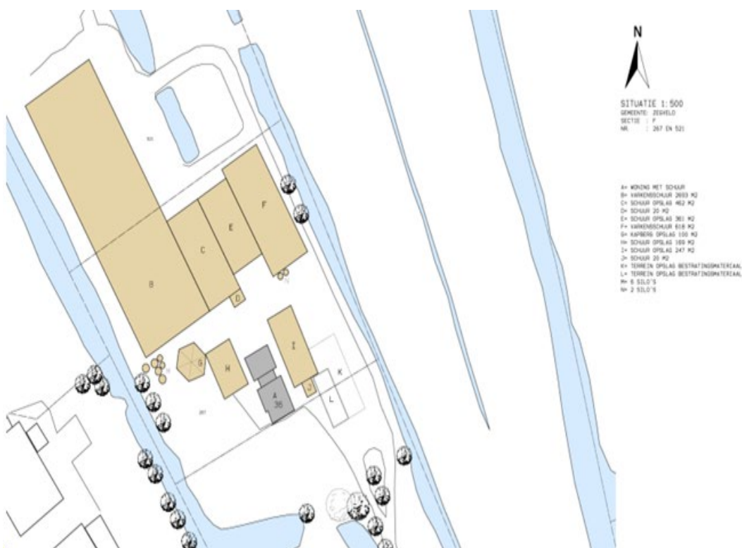
Figuur 2.5: Te slopen bebouwing (geel) planlocatie
