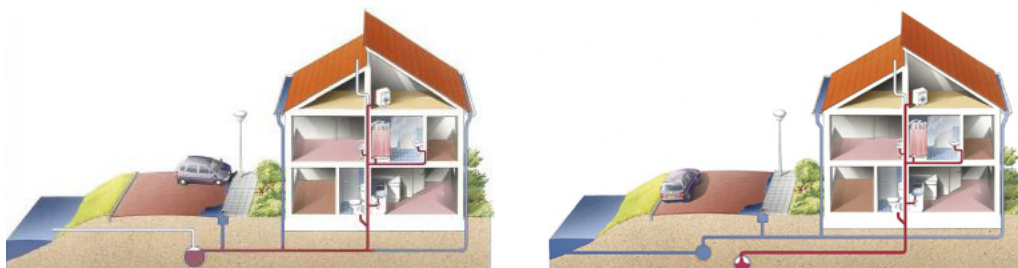
Figuur 1: Links gemengde riolering, rechts gescheiden riolering (bron: Paul Maas, Tilburg/Stichting RIONED)
