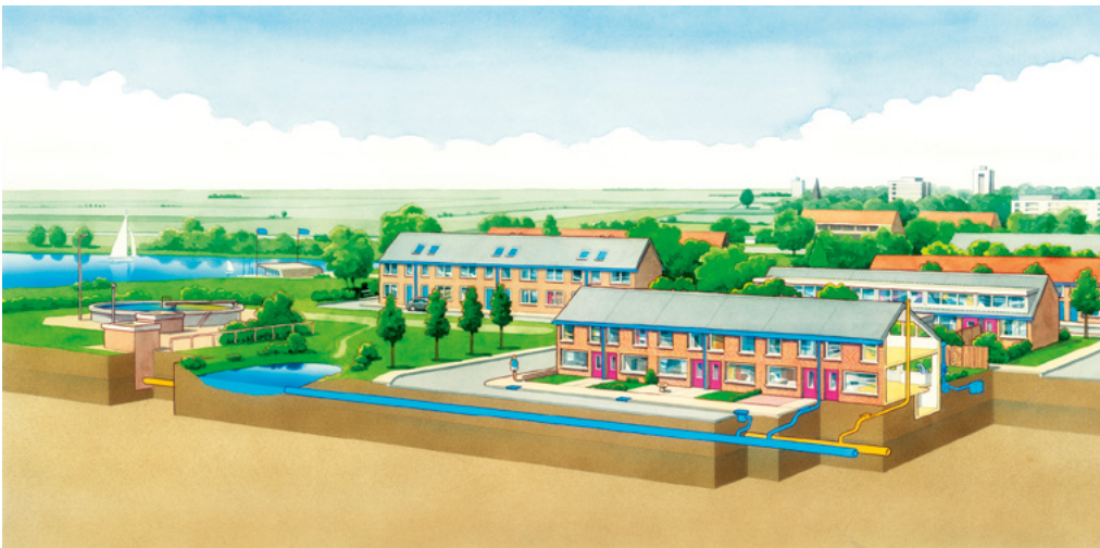
Figuur 3: Illustratie van riolering en rioolwaterzuivering in een woonwijk (bron: Stichting RIONED)
